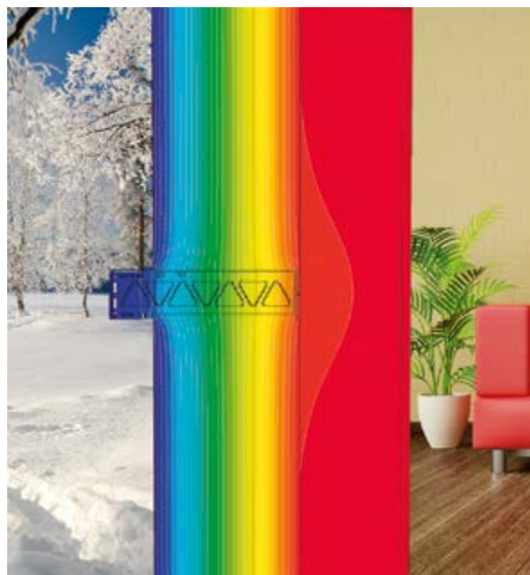
Abbildung 2 Minimale Wärmebrücke bei CROSSFIX®
