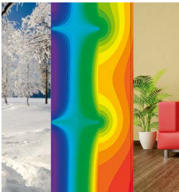
Abbildung 1 Ausgeprägte Wärmebrücke bei Aluminiumkonsolen
